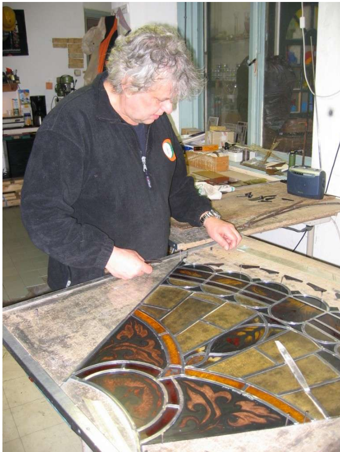
afbeelding 4: de glazenier met een van de trapeziumvormige delen van het venster
